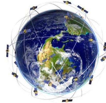
Le système GPS (*Global Positioning System*) est un réseau de 24 satellites qui émettent en permanence des informations codées permettant d'identifier précisément sa position géographique sur terre.
